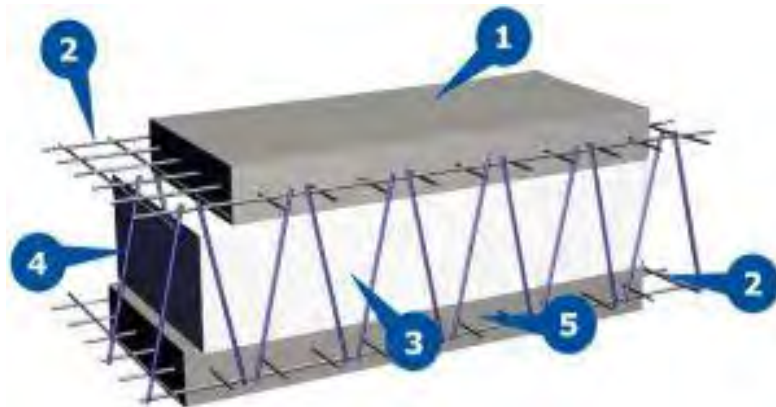
Схема 1. – СІП панель в розрізі[4]
