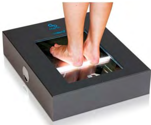
Рисунок 1 – 3D- сканування стопи
