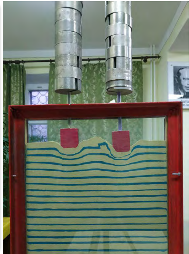
Рисунок 2 – Проведення фізичного експерименту (НДС без екрану)
