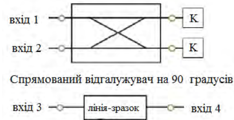
Рис. 1. Схема диференційного фазозсувача відбивного типу
