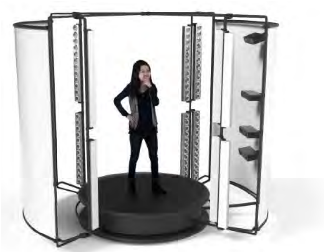
Рисунок 2 – Камера для високоточного 3Д-сканування людського тіла
