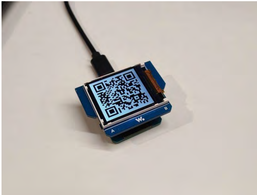
Рис. 3. Демонстрація способу відображення QR-коду за допомогою LCD дисплея
