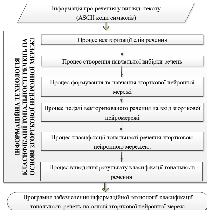
Рис. 1. Структура інформаційної технології класифікації тональності речень на основі згорткової нейронної мережі
