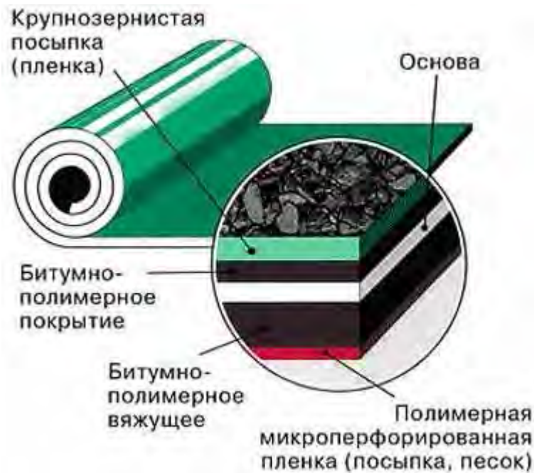
Рис.2 – Товщина і схема руберойду
