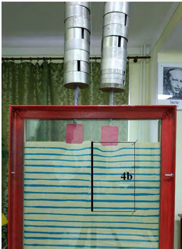
Рисунок 3 – Проведення фізичного експерименту (НДС з екраном = 4b)
