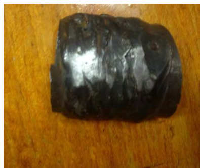
Рисунок 2. Зразок після вимірювання твердості
