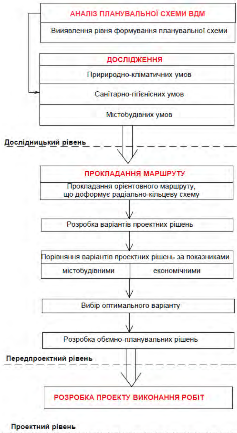
Рис. 1.1 – Алгоритм розвантаження ВДМ шляхом доформування радіально-кільцевої схеми
