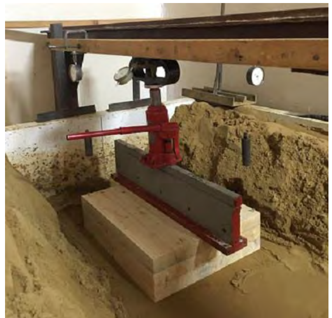
Рисунок 4 – Завантажений суцільний фундаментний блок
