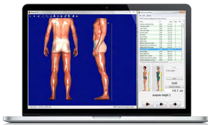
Рисунок 5 – Використання програми Anthroscan для зняття параметрів тіла
