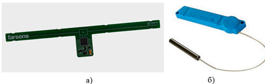
Рис. 5. Пасивний магнітометр фірми Farsens (а) [9] та напівпасивний радіочастотний сенсор A927ZET для вимірювання температури (б)
