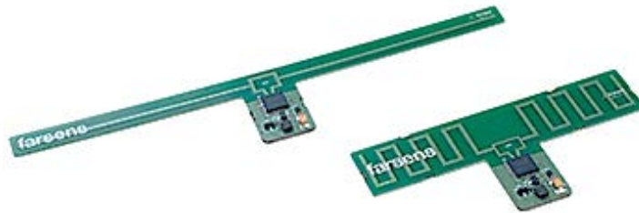
Рис. 3. Радіочастотний сенсор фірми Farsens призначений для визначення прискорення та орієнтації об'єкта в просторі
