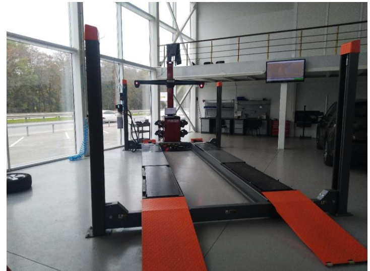
Система для контролю геометрії автомобіля
