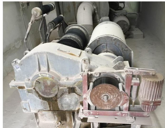
Підйомна лебідка скіпового підйомника
