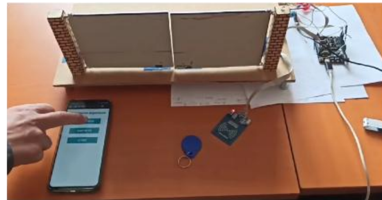
Налаштування та перевірка працездатності стенда під час управління зі смартфона
