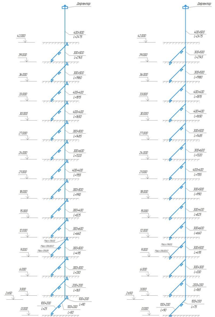
Аксонетрична схема витяжної вентиляції В4 (1:100)
