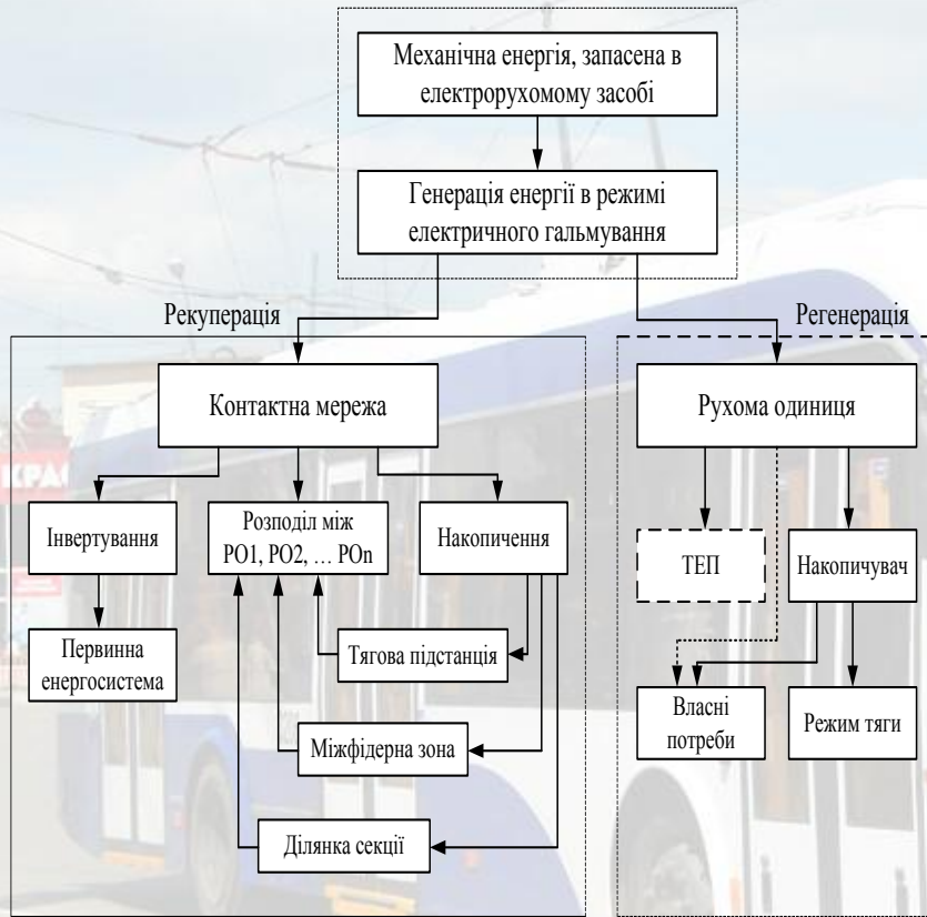
Рисунок 7 – Розподіл та використання енергії електричного гальмування
