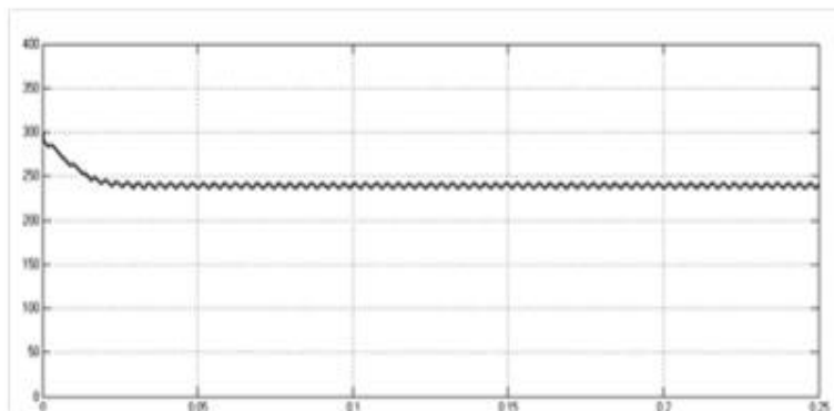
Рисунок 11 – Крива напруги на виході випрямляча
