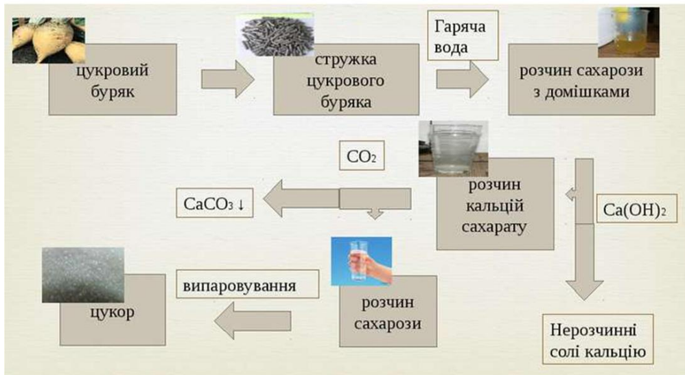
Схема одержання цукру із цукрового буряка
