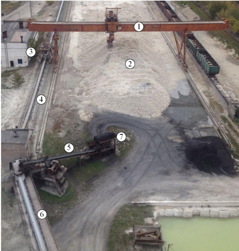
Подача вапняку до скіпового підйомника вапнякової печі
