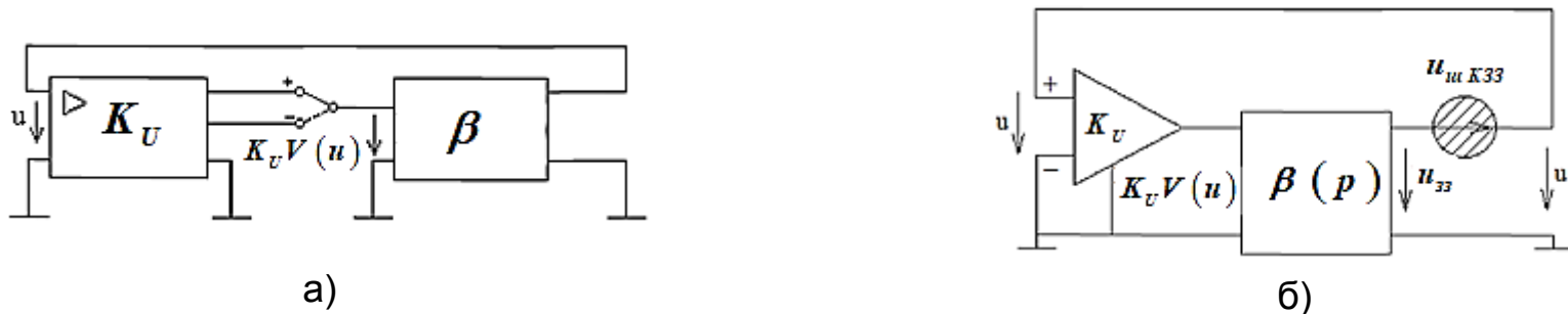
Рисунок 2 - Узагальнена схема RC- автогенератора (а) ; з еквівалентним джерелом природніх шумів (б)
