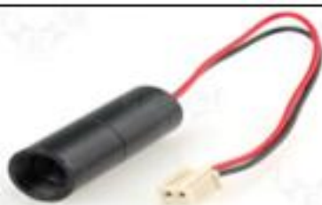
Лазерний модуль HLDPM12-632-25 Red 632 nm: -довжина хвилі: 632 нм; -вихідна потужність: 5 мВт; -напруга живлення: 3,3 В.
