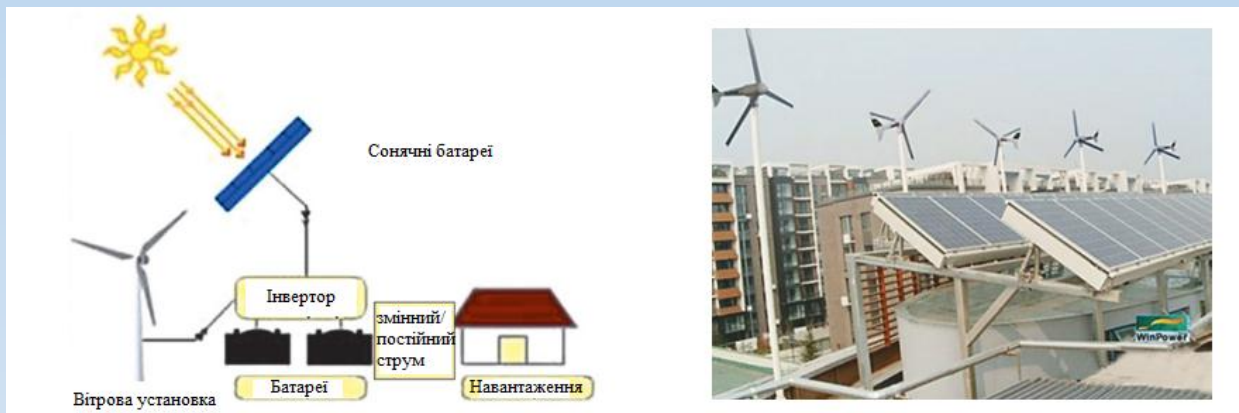
Рисунок 5 – Загальна схема і вид комбінованої системи електропостачання на основі ВДЕ
