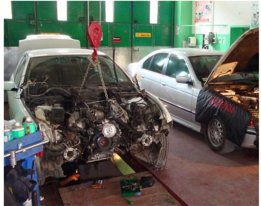
Процес демонтажу двигуна з автомобіля на СТО
