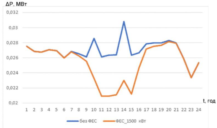
Рисунок 4 – Графік зміни втрат потужності протягом режимного дня з ФЕС 1500 кВт та без ФЕС для Φ-3
