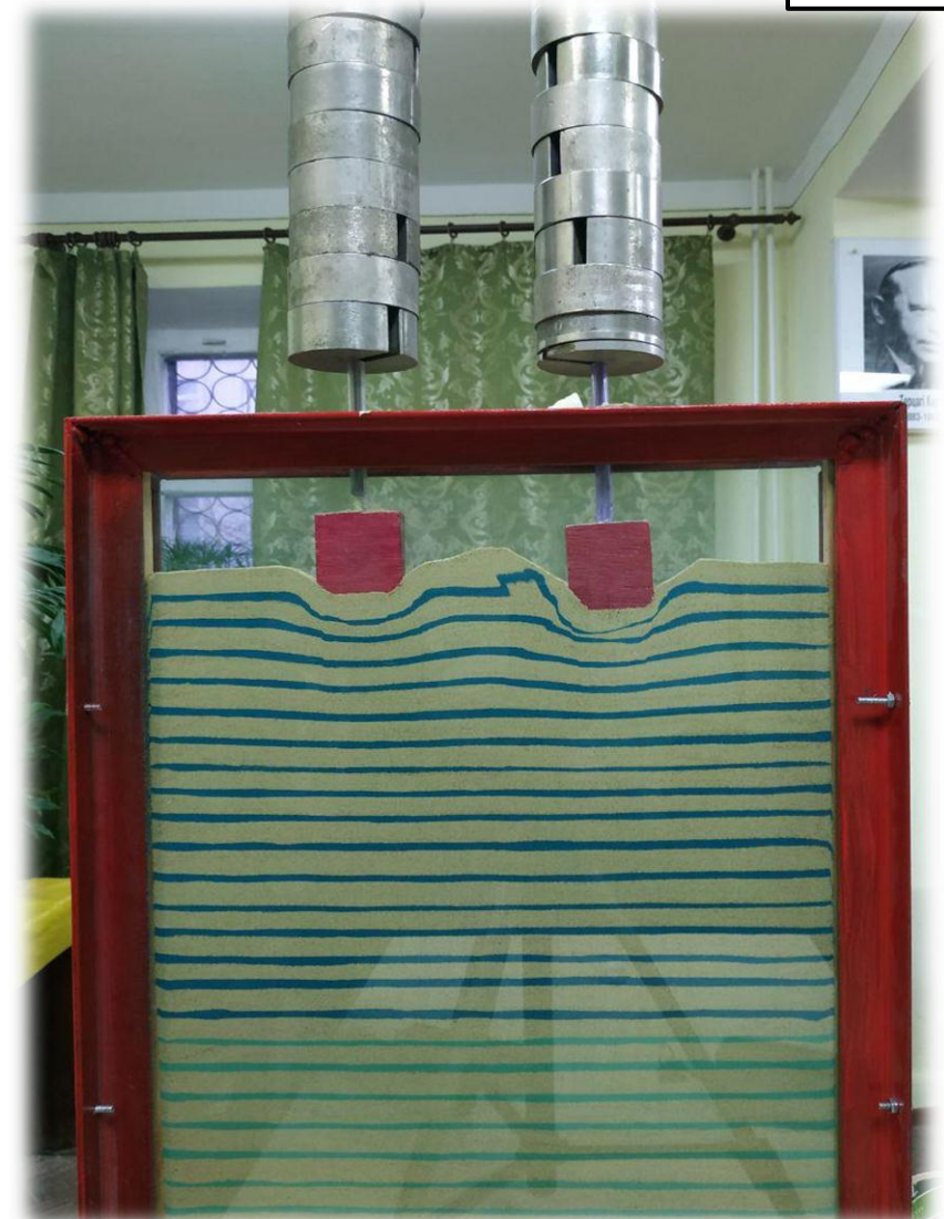
Рисунок 2 - Вплив навантаження двох фундаментів
