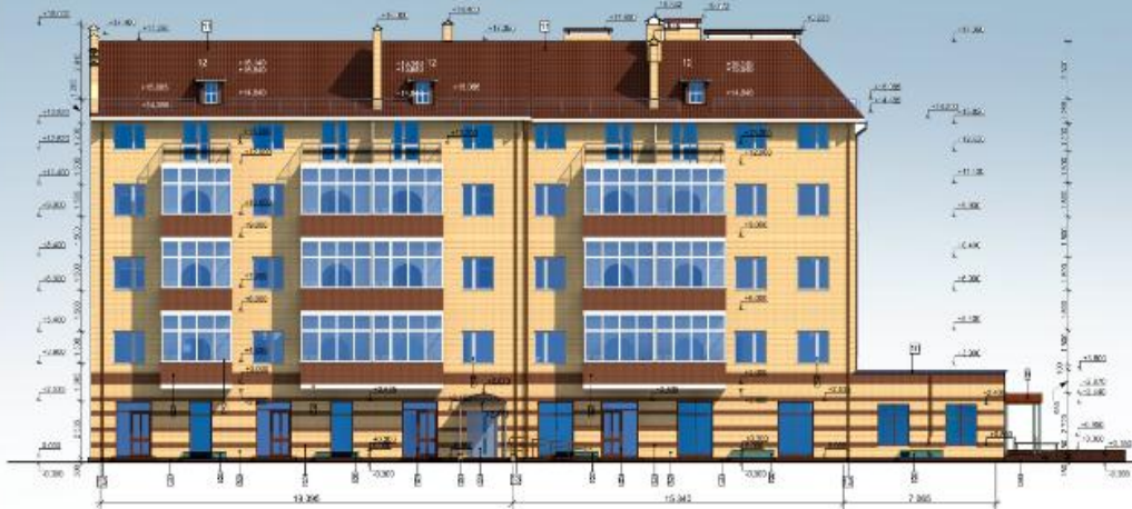
Фасад в осях 1с-11с М 1:100
