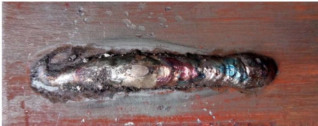
Зразок №3, наплавлений з шаром графіту товщиною – 2мм
