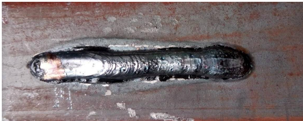
Зразок №2, наплавлений з шаром графіту товщиною – 1мм
