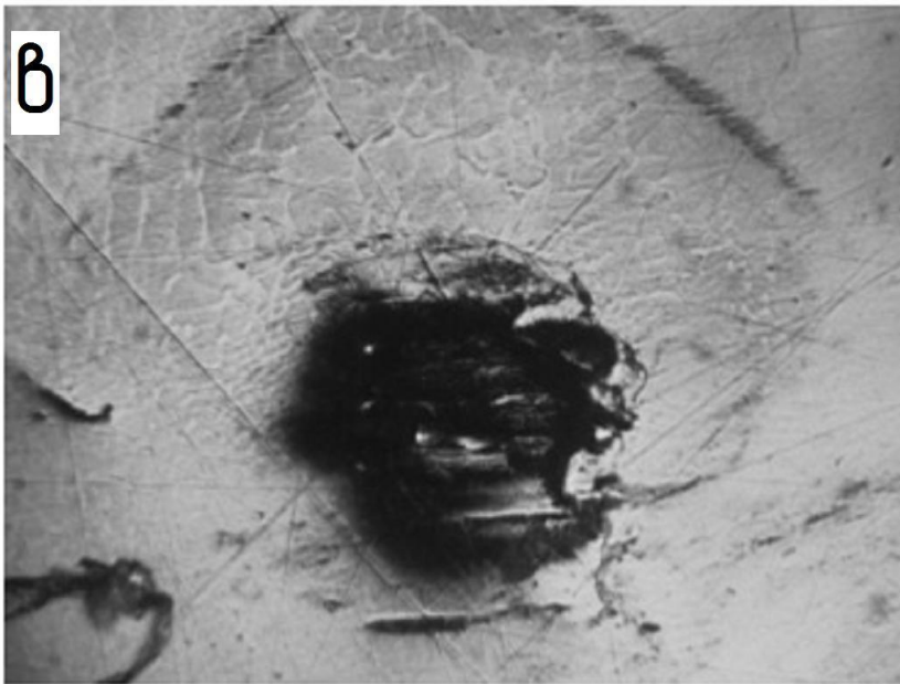
Рисунок 3.4 – Структура металу третього зразка: а – наплавлений метал; б – основний метал; в – раковина в наплавленому металі; г – тріщина в перехідній зоні
