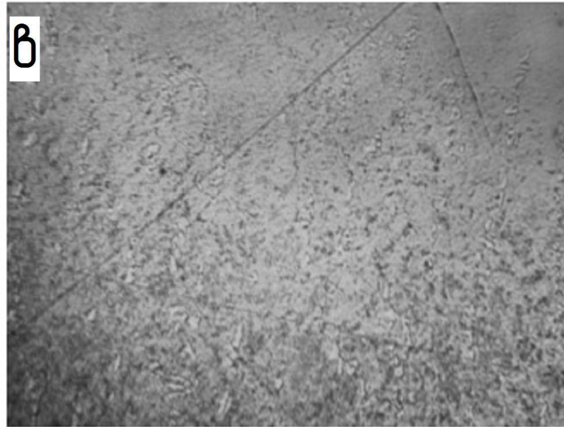
Рисунок 2 – Структура металу першого зразка: а – наплавлений метал; б – основний метал; в – перехідна зона
