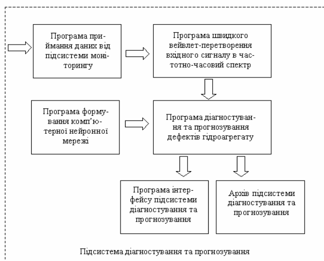
Рис.1. Підсистема діагностування і прогнозування дефектів гідроагрегату
