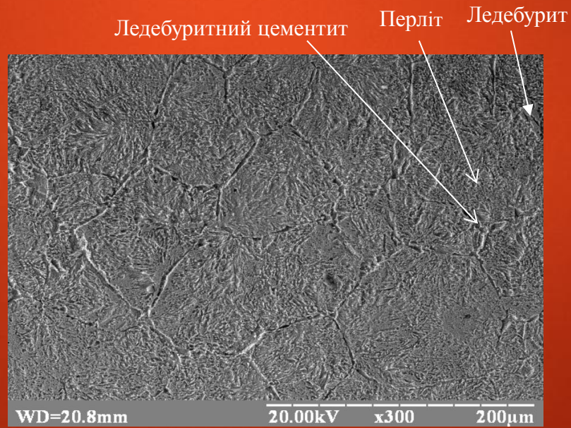
Верхній підшар наплавленого високовуглецевого покриття
