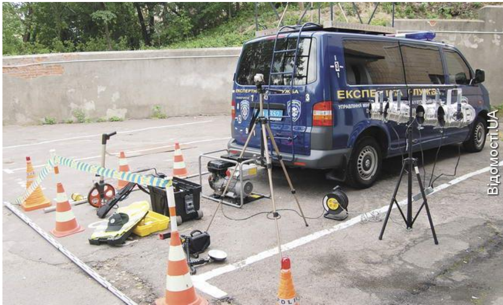
Рисунок 2 – Пересувна лабораторія з проведення автотехнічної експертизи на місці ДТП НДЕКЦ при МВС України у Волинській області
