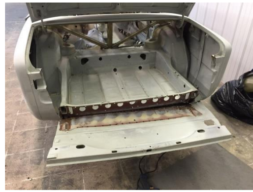
Рисунок 13 – Для початку висвердлюється точкове зварювання в районі кріплення лонжеронів - а. Свердління по периметру – б
