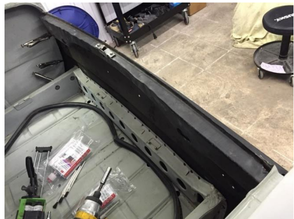
Рисунок 18 – Зачищається панель - а. Клей для панелей – б
