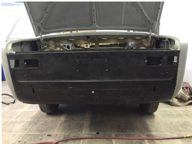
Рисунок 18 – Зачищається панель - а. Клей для панелей – б
