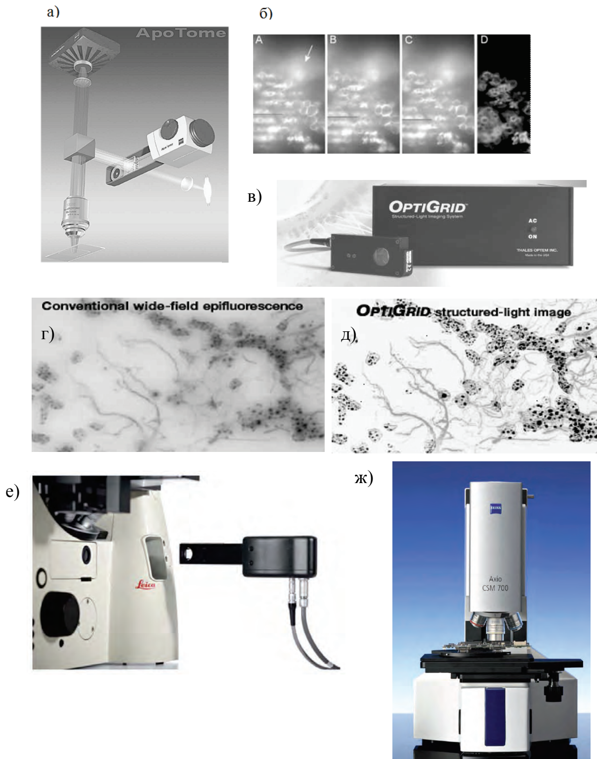
Рис. 7. Модули ПМО для оптических микроскопов и микроскопы с проекционной поперечной ПМО: а) общий вид модуля ПМО Zeiss APOtome; б) формирование ПМО на поверхности образца и результирующее цифровое изображение. в) общий вид модуля ПМО OptiGrid; г) цифровое изображение без использования модуля ПМО OptiGrid; д) цифровое изображение при использовании модуля ПМО OptiGrid; е) общий вид модуля ПМО OptiGrid с автофокусировкой в системе Leica Intelligent SIM; ж) микроскоп с ПМО Zeiss Axio CSM 700
