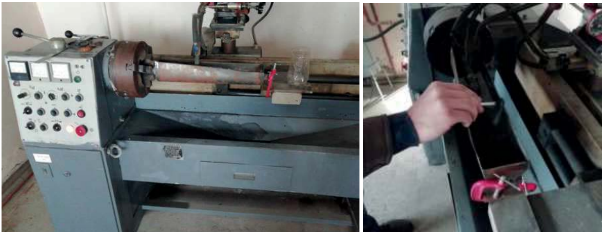
Рис. 1. Установка для наплавлення з водяним охолодженням
