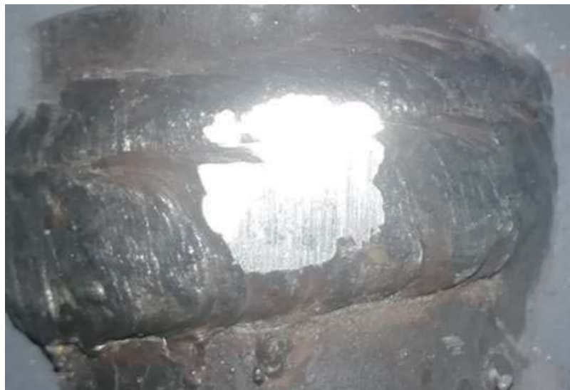
Рис. 2. Макрошліф наплавленого покриття
