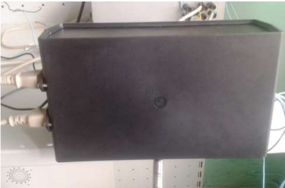
Рис. К.2. Лабораторний зразок засобу контролю концентрації двоокису вуглецю у димових газах котельних установок (зовнішній блок)
