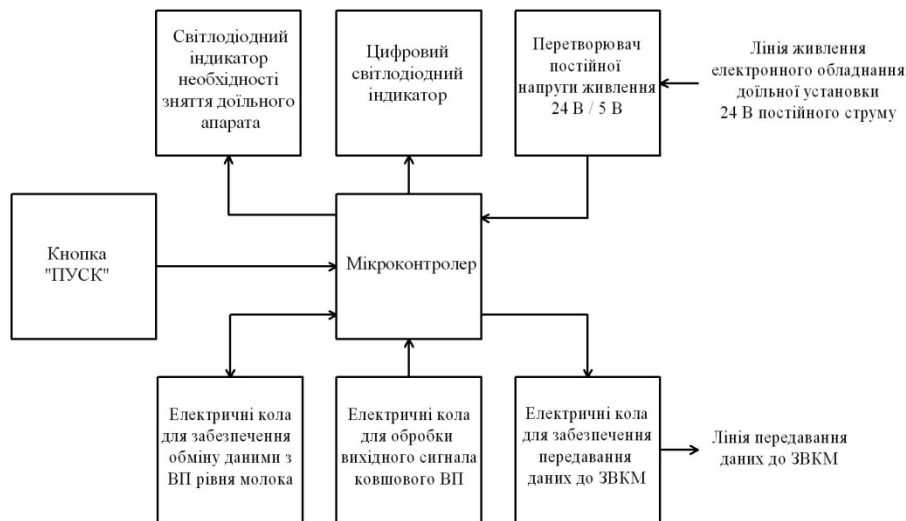
Рисунок 5.1 – Електрична структурна схема БЗПД «ІД-02»
