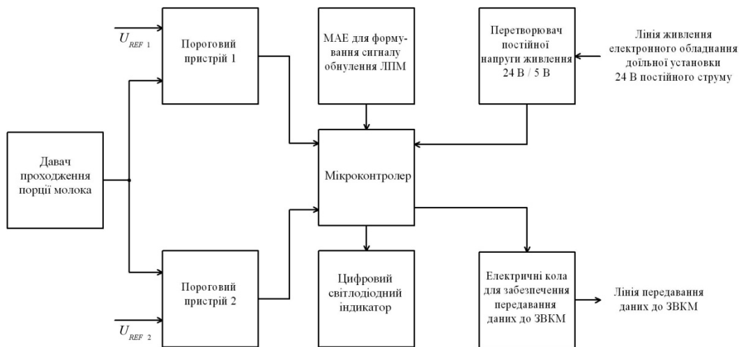
Рисунок 5.11 – Електрична структурна схема ЛПМ «СПМ-02»
