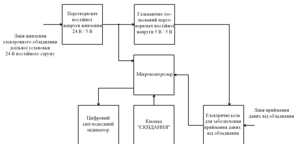
Рисунок 5.12 – Електрична структурна схема ЗВКМ «ЦНС-2»
