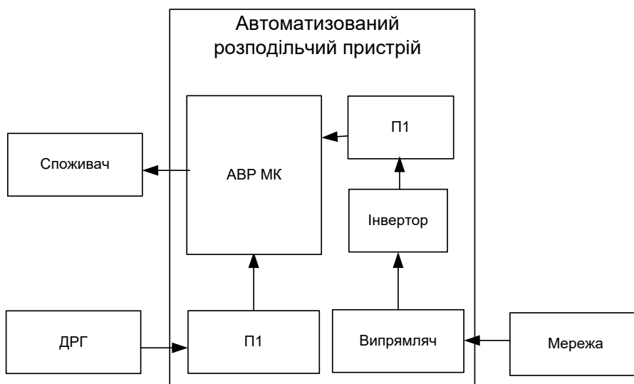
Рис. 2. Структурна схема автоматизованого розподільчого пристрою
