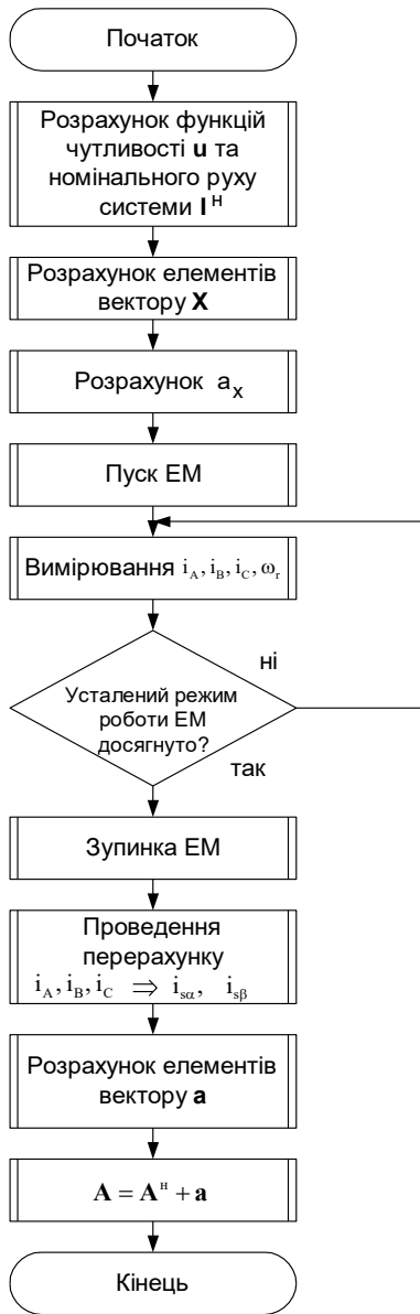
Рис. 1. Алгоритм ідентифікації роторних параметрів ЕМ за допомогою функцій чутливості
