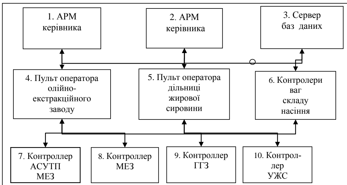
Рис. 5.19. Схема зв'язків елементів обчислювальної системи
