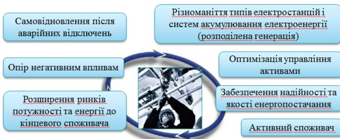
Рисунок 2.1 – Характеристики необхідні для досягнення ключових вимог Smart Grid
