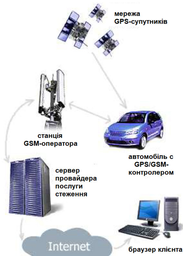
Рисунок 11.6 – Схема доставки даних про місцезнаходження автомобіля за допомогою мобільного зв'язку через Інтернет [5]
