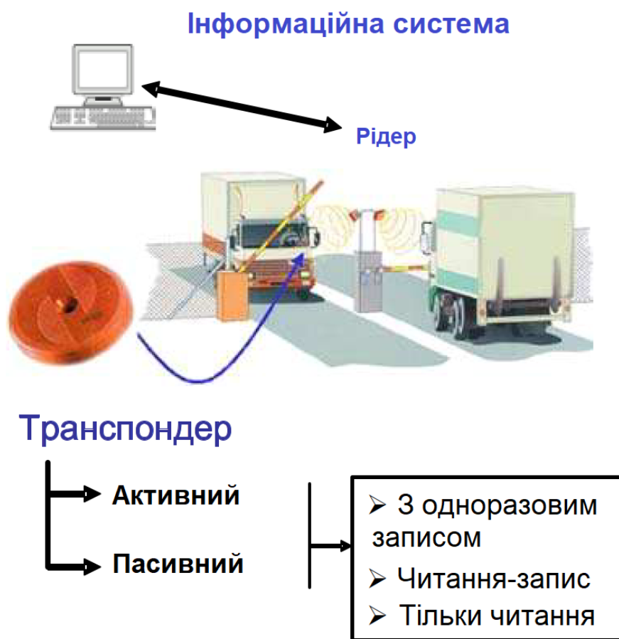
Рисунок 10.1 – Зчитування даних з радіочастотних міток [4, 5]
