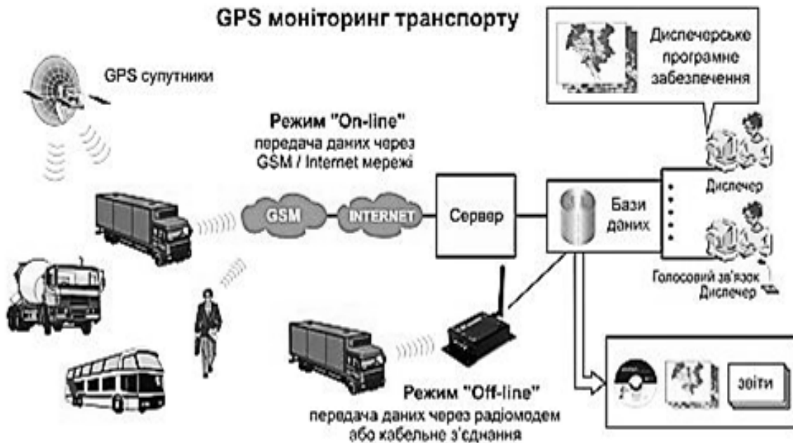
Рисунок 6.7 – Схема дії GPS/GSM моніторингу [10, 15, 18]
