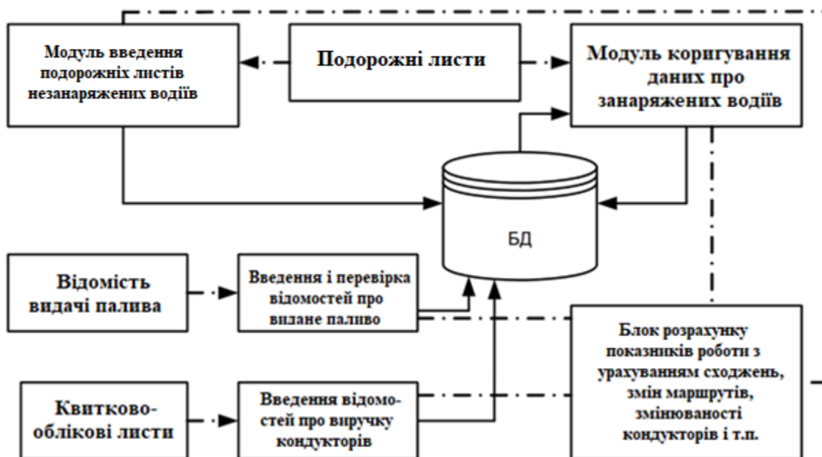
Рисунок 5.5 – Функціональна схема АРМ таксування шляхових листів [10]
