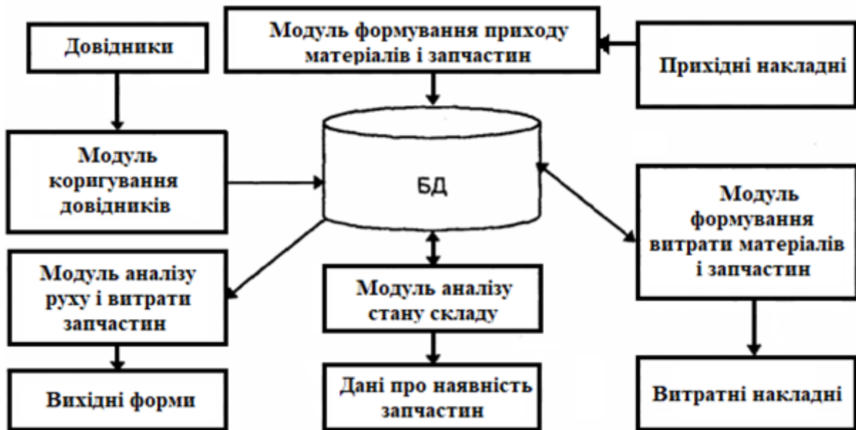
Рисунок 5.9 – Функціональна схема АРМ складу [10]
