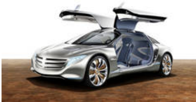
Der F 125 – ein Forschungsfahrzeug mit Flügeltüren und Brennstoffzellenantrieb von Mercedes
