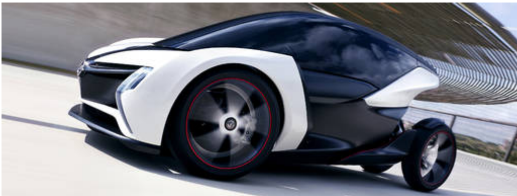
Opel-Elektrostudie "Rak e" ist zwei Drittel leichter als ein Corsa. Zwei Passagiere finden hier hintereinander Platz.
