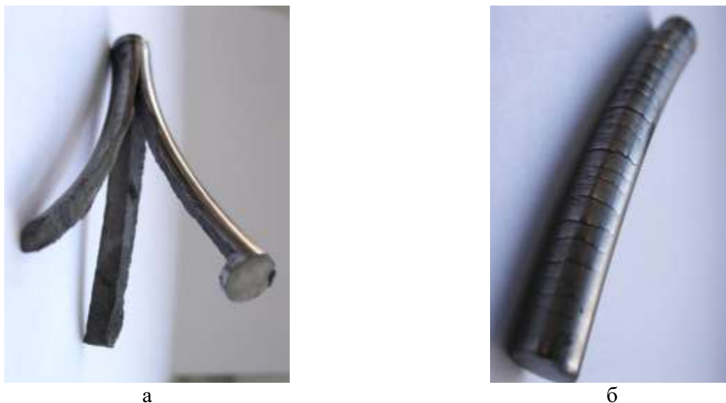
Рисунок 2 – Поведінка зразків системи W-Ni-Fe в процесі редукування при куті нахилу робочого конуса 7^\circ (а – тріщина на осі симетрії зразка, б – тріщини на поверхні зразка).
