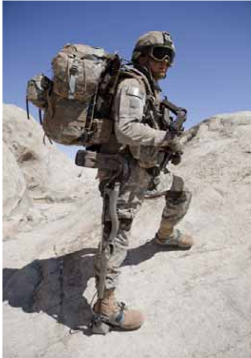
Рис.8. Екзоскелет HULC - Human Universal Load Carrier (Lockheed Martin)
