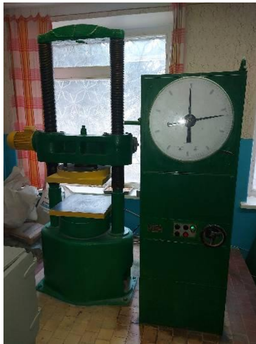
Рис. 3.6 Гідравлічний прес ПСУ-125 для визначення міцності при вигині Результати представлені в табл. 3.3
