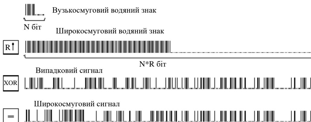
Рисунок 5.6 – Розширення спектра за допомогою псевдовипадкової послідовності
