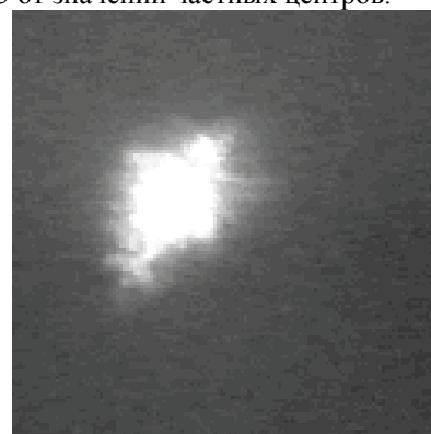
Рис. 4. Выбранное эталонное изображение лазерной трассы (размерность изображения 128×128 пикселей)
