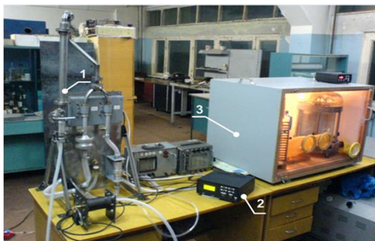
Рисунок 1 – Основні елементи мікротунелю МКТ-2: 1 – пробовідбірний пристрій; 2 – електронний модуль керування; 3 – камера для зважування фільтрів
