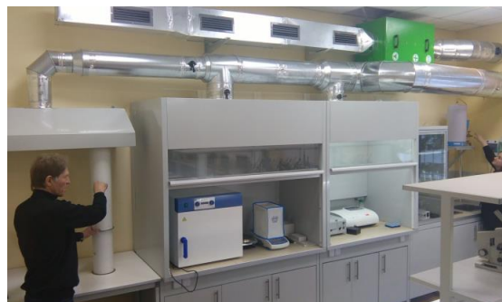
Рисунок 3 – Установка для досліджень аеродинамічних процесів в трубах КУ і ТД
