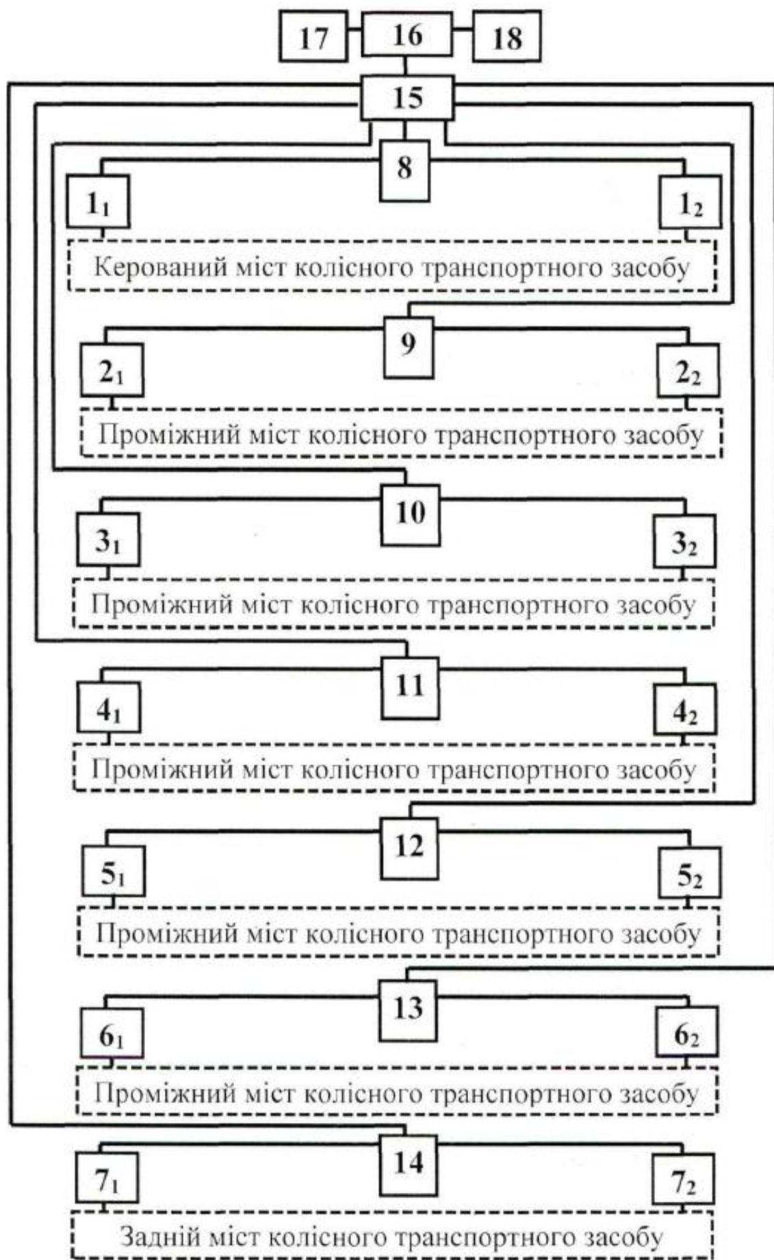
Корисна модель належить до систем для вібродіагностування ходової частини семивісних колісних транспортних засобів, яка заснована на вимірюванні значень параметрів віброприскорення, що генерується при взаємодії вузлів (елементів) керованого, п'яти проміжних і заднього мостів колісних транспортних засобів. Область застосування - контроль технічного стану (виявлення несправностей, визначення місця розрегулювання) вузлів керованого, п'яти проміжних і заднього мостів колісних транспортних засобів.
