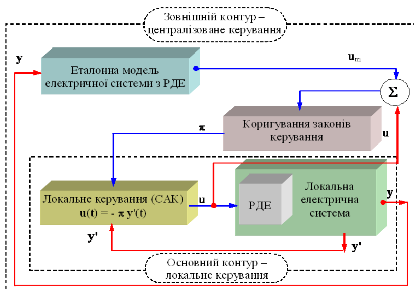
Рисунок 4.21 – Адаптивна система керування РДЕ з еталонною моделлю
