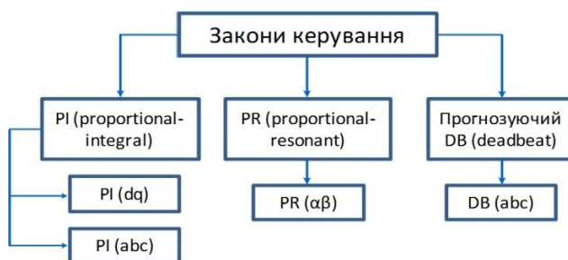
Рисунок 1.7 – Класифікація законів керування інверторами СЕС
