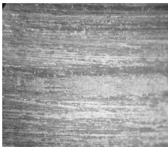
Рисунок 4.9 – Загальний вигляд поверхонь пари тертя зразків (а) та контртіла (б) після зношування в умовах сухого тертя
