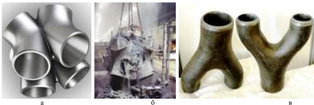
Рисунок 6 - Трубчасті вузли: зовнішній вигляд очищеного виливка (а); видалення такого виливка з піщаної форми (б) та виливки, що виготовлені методом ЛГМ у ФТІМС НАН України (в).
