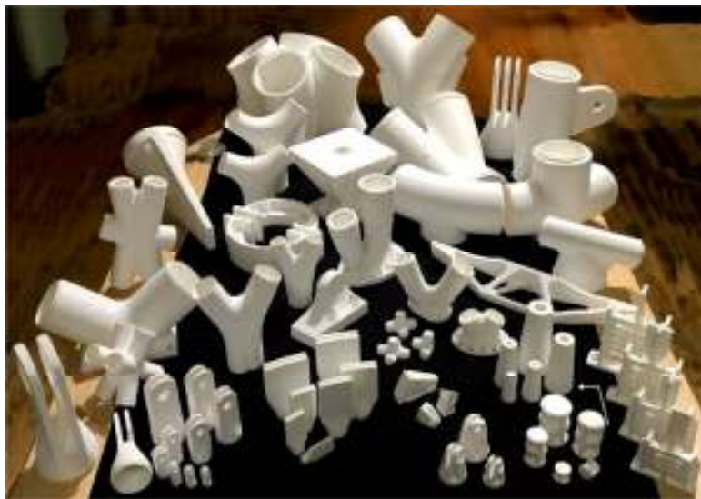
Рисунок 4 - Моделі вузлів різноманітних конфігурацій для модульних металокопструкцій.
