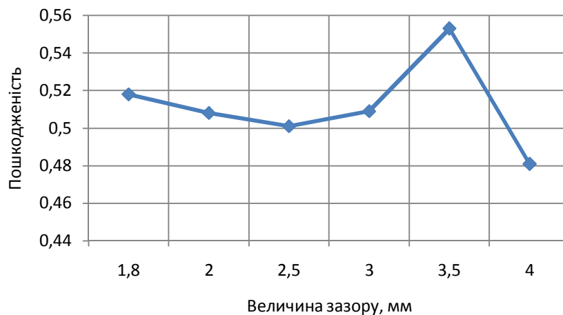
Рисунок 9 – Залежність пошкодженості матеріалу від зазору між матрицею і пуансоном
