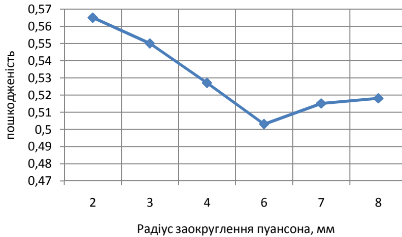
Рисунок 8 – Залежність пошкодженості матеріалу від радіуса заокруглення пуансону
