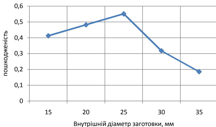
Рисунок 7 – Залежність пошкодженості матеріалу від внутрішнього діаметра заготовки
