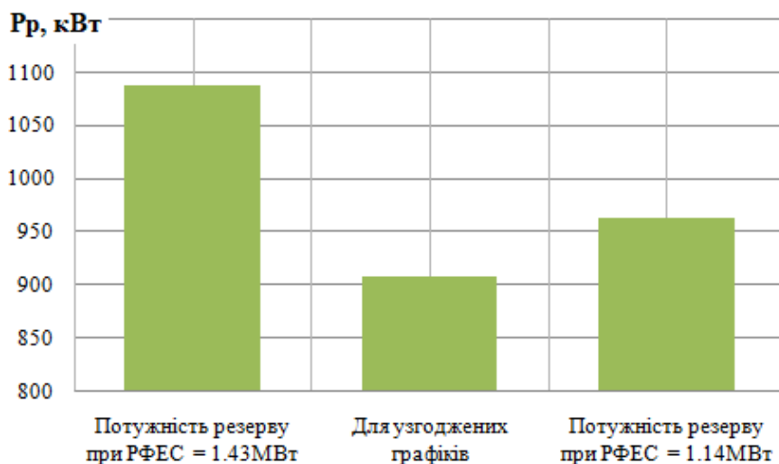
Рис. 4.34. Зміна потужності резерву для різних засобів підвищення балансової надійності ЛЕС
