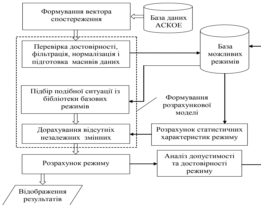
Рис. 3.1. Блок-схема алгоритму визначення параметрів поточного режиму
