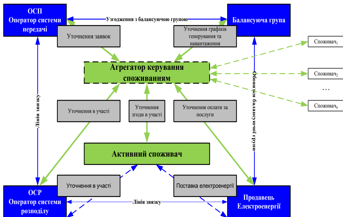
Рис. 4.18. Узагальнена схема принципів реалізації керування попитом
