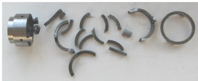
Рис. 2. Конструкція поршня-прорізної пружини побудованої, за загальновідомими принципами для прорізних пружин
