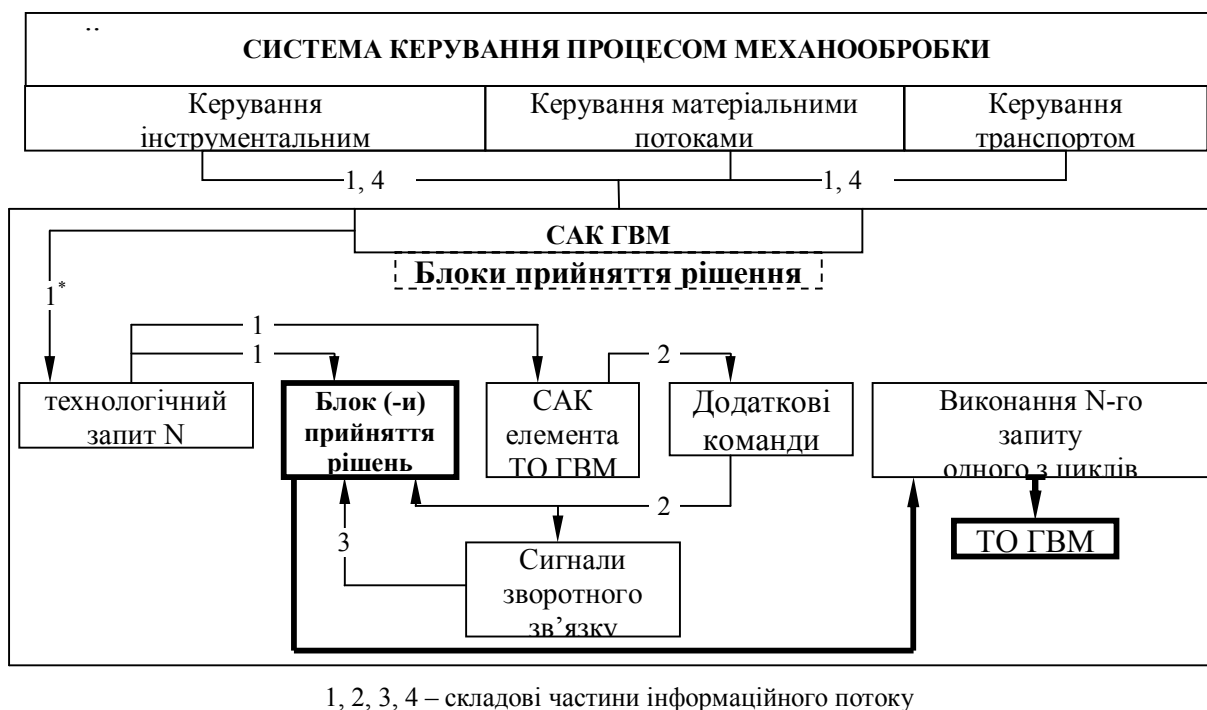
1, 2, 3, 4 – складові частини інформаційного потоку Рис. 2. Система автоматизованого керування процесом механообробки
