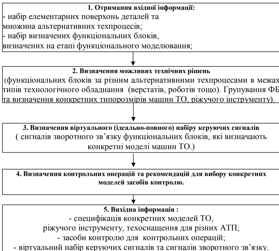
Рис. 3. Узагальнена схема алгоритму керування технологічними процесами
