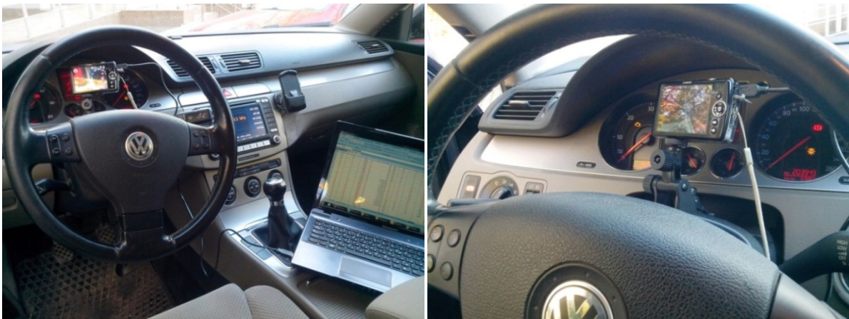
Рис. 3. Установлення устаткування на автомобіль Volkswagen Passat B6 для проведення експериментальних досліджень
