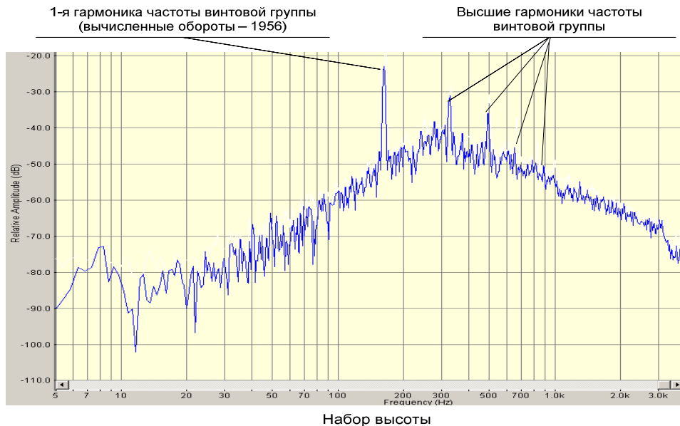
Рисунок 2 – Анализ спектров шума турбовинтового самолета
