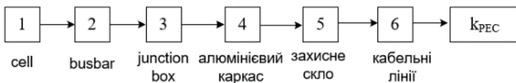
Рис. 4. Структурна схема моделі коефіцієнта залишкового ресурсу ФЕМ
