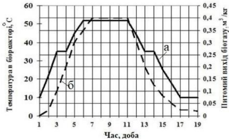
Рис. [1] Залежність виходу біогазу, від вибору температурного режиму. а - температура в реакторі, б - вихід біогазу
